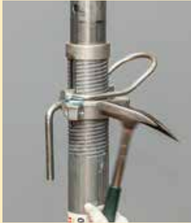
Lyönti vasaralla säätömutterin sakaraan ei vahingoita holvitukea.
