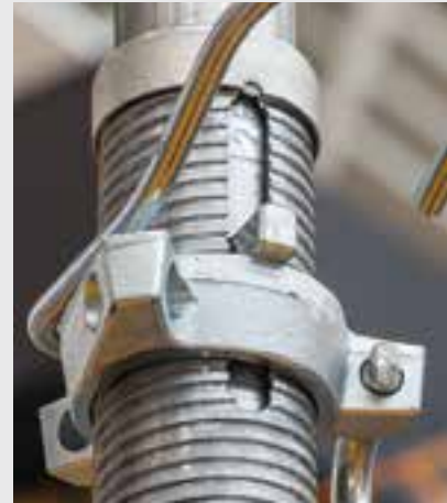
Säätömutterin tukipinta helpottaa löysäämistä.
